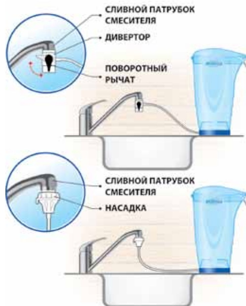
Рис. 4.17. Варианты подключения фильтра.
