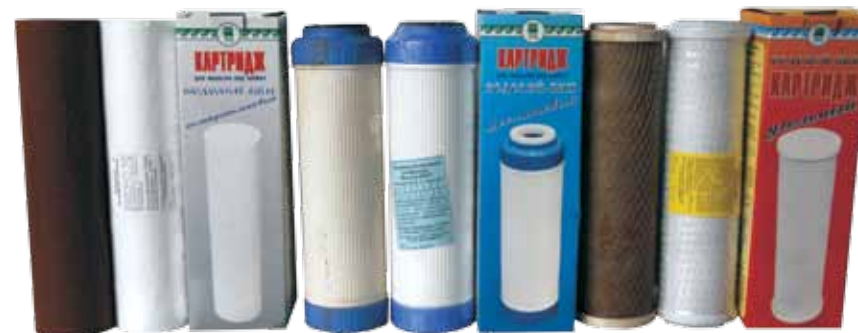
Рис. 2.2. Картриджи фильтра под мойку «Водолей-БКП»: полипропиленовый, цеолитовый и угольный – отработанные и новые (для сравнения).
