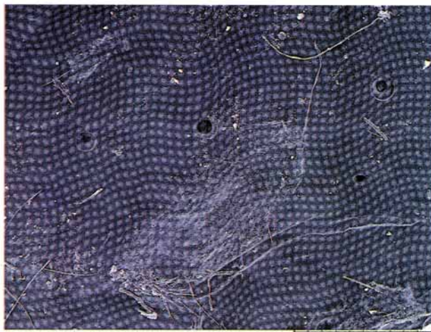
Рис. 4. Вид пленки хитозанового геля. Снимок получен на сканирующем электронном микроскопе HITACHI TM-1000 (увеличение 4500 крат)
